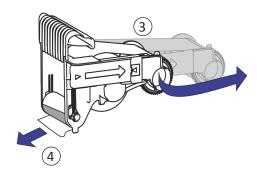
5. 将色带匣装入打印机中, 然后关上打印机盖。
