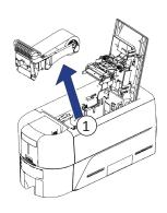
2. 去掉印刷色带匣的包装。色带匣以闭合状态 运输。
